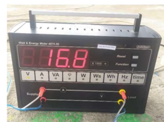
Gambar 6 Watt Energi Meter
